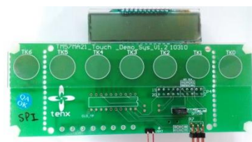
图4-主设备+SPI Touch Key
